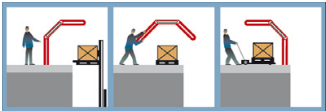
Figure 17. Principe de fonctionnement d'une barrière-écluse.
