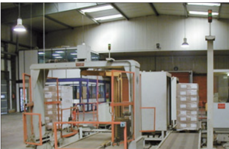
Figure 1. Transtockeur dans un entrepôt à température négative.
