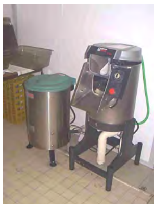
L'éplucheuse doit permettre, à l'aide de filtre approprié, la récupération des épluchures, en empêchant leur évacuation à l'égout [doc. COSTIC]
